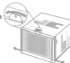
3. Caso deseje, conecte ao dreno uma mangueira com diâmetro de 3/8" para drenagem da água condensada pelo produto.
