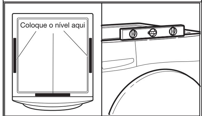
Retire o papelão debaixo da lavadora. Coloque um nível nas bordas superiores da lavadora, verificando cada lado e a frente. Se não estiver nivelada, incline a lavadora e ajuste os pés para cima ou para baixo, como mostrado nas etapas 15 e 16, repetindo conforme necessário.
