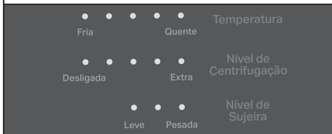
As luzes indicadoras mostrarão as configurações padrão para o ciclo selecionado. Para ajustar uma função, toque na opção - Temperatura, Nível de Centrifugação, ou Sujeira. Ajustando as funções, o Tempo Restante Estimado pode ser alterado. Cargas muito compactadas, cargas desbalanceadas ou espuma excessiva podem fazer com que a lavadora de roupas também prolongue o tempo de ciclo.
