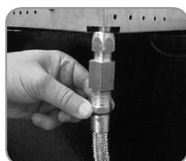
1. Encaixar o adaptador no engate rápido de seu cooktop, com a porca não rosqueada. Certifique-se de que o adaptador foi bem encaixado ao engate rápido.
