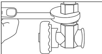
6. Rosqueie a mangueira metálica no registro de gás com o auxílio de duas chaves de boca. Utilize pasta vedante para auxiliar na vedação. O ponto de abastecimento de gás tem que permitir a instalação da mangueira flexível metálica de maneira que ela fique paralela a parede evitando-se assim um estrangulamento.
