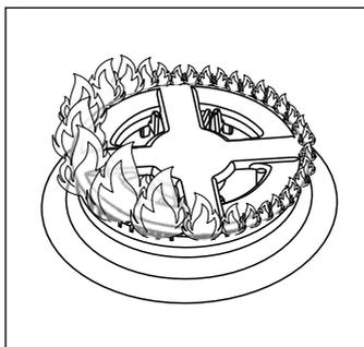
2. Após a instalação do queimador, verifique o acendimento, seguindo as instruções do item “5.4. Acendendo os queimadores da mesa”. O posicionamento incorreto do queimador ou da capa irão resultar em dificuldade de ignição e chamas irregulares (como mostrado na figura ao lado).
