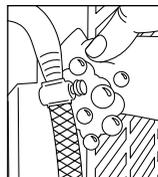
7. Após a instalação, abra o registro de gás e utilizando uma esponja com água e sabão, verifique se há vazamento em todas as conexões, incluindo toda a extensão da mangueira. Se houver formação de bolhas na conexão, refaça-a. Se houver bolhas em qualquer região da mangueira, efetue a substituição da mesma.
