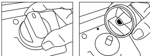
Para facilitar a limpeza, os botões da mesa podem ser removidos. Para removê-los, simplesmente puxe-os para cima quando na posição “fechada”. Para montá-los novamente, basta encaixá-los no eixo, conforme a figura ao lado.
