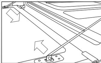
1. Abra a porta do forno e pressione as hastes da prateleira para dentro, conforme figura, para que as mesmas se soltem da porta.
