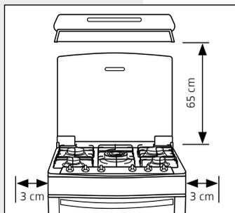
Para o local de instalação, deve-se prever um vão mínimo de 65 cm entre a mesa e qualquer superfície acima dela, como armários ou outros produtos, como coifas e depuradores (modelos BF55NCR, BY55PCR, BF55GDR, BF56NCB, BF55NDB) e uma distância mínima de 3 cm em toda a volta do fogão, para circulação de ar.
