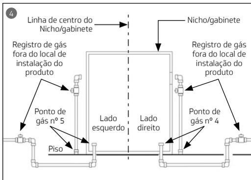
1. Observe a Figura 1 para identificar a posição do ponto de gás que você possui em sua residência para a instalação do fogão.
