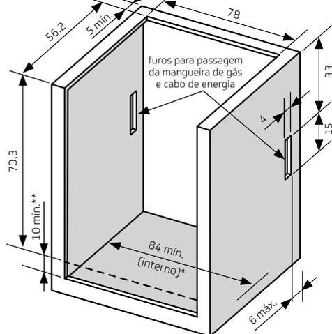
\* Esta dimensão é importante para garantir um afastamento mínimo e simétrico entre a parede do móvel e o produto.
