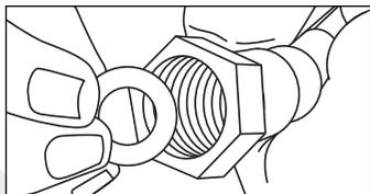
4. Coloque a arruela de vedação dentro da rosca interna da mangueira metálica.
