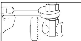
1. Rosqueie a mangueira metálica no registro de gás da parede com o auxílio de duas chaves de boca. O ponto de abastecimento de gás tem que permitir a instalação da mangueira flexível metálica de maneira que ela fique paralela a parede evitando-se assim um estrangulamento.
