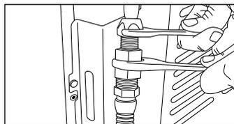
3. Coloque a porca do adaptador na entrada de gás. Em seguida, encaixe o adaptador e rosqueie a porca de fixação. Utilize duas chaves de boca para auxiliar o aperto.
