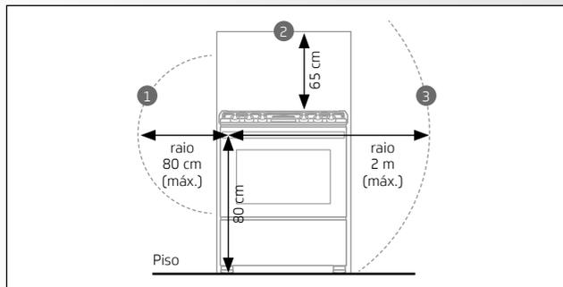
1. Região permitida para a instalação de tomadas. Comprimento do cabo de alimentação: 90 cm. Certifique-se de que a tomada esteja, no máximo, a 80 cm da parte superior de seu produto.
