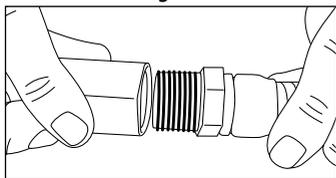
1. Rosqueie o adaptador junto à mangueira metálica flexível. Para auxiliar na vedação, utilize pasta vedante.
