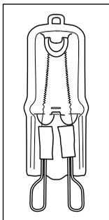
4. Encaixe a nova lâmpada no soquete (veja a posição correta na imagem ao lado). Não toque na superfície da lâmpada halógena com as mãos desprotegidas. O contato com a mão pode reduzir o tempo de vida da lâmpada.
