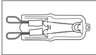
**Utilize somente lâmpadas de 25W do tipo G9. Assegure-se de que o aparelho está desligado antes de substituir a lâmpada, para evitar a possibilidade de choque elétrico. Para instalar/trocar a lâmpada do forno, siga as instruções da página 26.**
