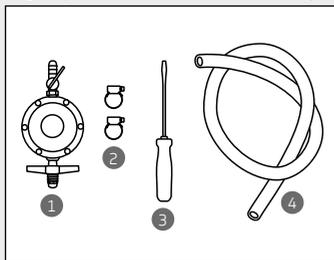
1. Regulador de pressão de gás com 2,75 kPa (válvula do botijão) conforme NBR 8473. Nunca instale regulador de pressão com prazo de validade vencido.
