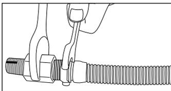
2. Faça a fixação com auxílio de duas chaves de boca.
