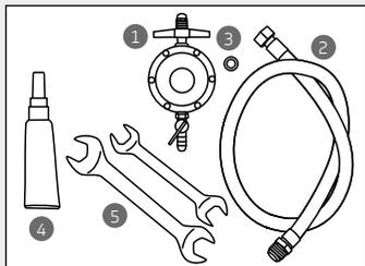
1. Regulador de pressão de gás com 2,75 kPa com rosca de 1/2" (válvula de botijão) conforme NBR 8473 (somente para instalação de produto com botijão). Observe a data de validade.
