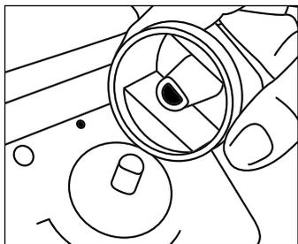
Para facilitar a limpeza, os botões da mesa podem ser removidos. Para removê-los, simplesmente puxe-os para cima quando na posição "fechada". Para montá-los novamente, basta encaixá-los no eixo, conforme a figura ao lado.
