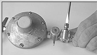
3. Coloque a outra braçadeira na extremidade oposta da mangueira. Em seguida, conecte a mangueira no regulador de pressão e, então, aperte a braçadeira com o auxílio de uma chave de fenda.
