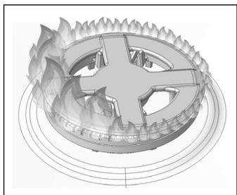
2. Após a instalação do queimador, verifique o acendimento, seguindo as instruções do item "Acendendo os queimadores da mesa". O posicionamento incorreto do queimador ou da capa irão resultar em dificuldade de ignição e chamas irregulares (como mostrado na figura ao lado).
