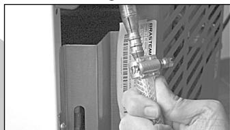
1. Coloque a braçadeira de metal em uma das pontas da mangueira. Em seguida, encaixe a mangueira no ponto de entrada de gás.
