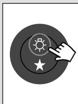
Para acender a luz do forno, aperte para cima o botão dupla função. Para apagar a luz do forno, retorne o botão para posição desligada (central).
