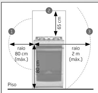
1. Região permitida para a instalação de tomadas. Comprimento do cabo de alimentação: 90 cm. Certifique-se de que a tomada esteja, no máximo, a 80 cm da parte superior de seu produto.
