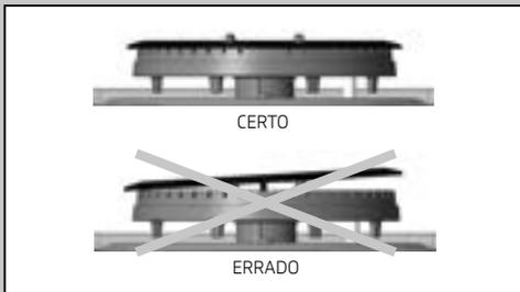
3. Após a instalação do queimador, verifique o acendimento, seguindo as instruções do item "5.4. Acendendo os queimadores da mesa". O posicionamento incorreto do queimador ou da capa irão resultar em dificuldade de ignição e chamas irregulares (como mostrado na figura ao lado).
