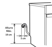
Instale a mangueira de drenagem em um cano exclusivo para escoamento, próximo à Lava Louças, com diâmetro mínimo de 5 cm. Para instalação em
