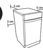
Posicione a Lava Louças no local, deixando-a no mínimo 5 cm afastada da parede ou de outros móveis ou objetos, para ventilação e saída de vapores. Essa mesma recomendação deverá ser
