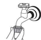
Rosqueie a extremidade da mangueira de entrada de água na torneira e a outra extremidade (conexão em L) na válvula de entrada da
