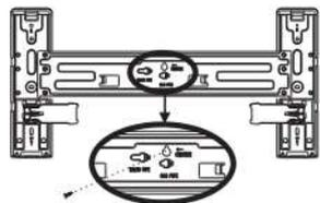
4. Fixe o suporte pelo furo central e, ajuste a placa de montagem na horizontal com um nível de bolha, para que não haja desnivelamento da unidade. Na placa, existem duas abas para posicionar o nível de bolha.
