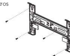
6. Solte o parafuso central e retire a placa de montagem da parede.
