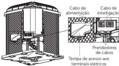
4. Passe os cabos por dentro dos prendedores de fios. Solte os parafusos para permitir a passagem dos cabos e recoloca os parafusos novamente, garantindo que os cabos fiquem bem presos.
