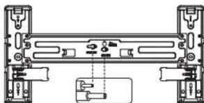
3. Insira as porcas existentes no kit de instalação nas tubulações da parede.
