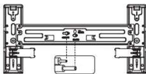
3. Faça um furo para fixação do parafuso no centro da placa de montagem e coloque a bucha na parede.
