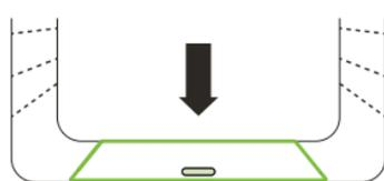
Certifique-se do correto posicionamento do furo de acendimento, que deve ficar voltado para a porta, conforme a figura.
