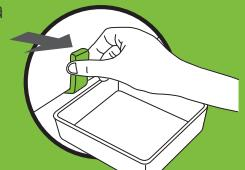
Retire a tampa do dreno localizada no fundo do compartimento interno do freezer.
