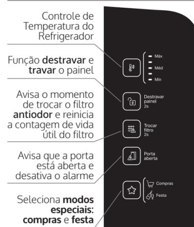
será possível acionar nenhuma função ou fazer ajustes na temperatura do refrigerador. Para destravar o painel, pressione por 2 segundos a tecla **"Destravar painel"** até que a luz do símbolo se apague.
