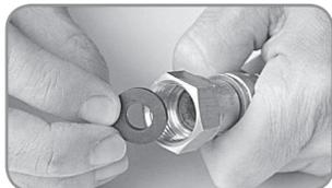
4. Coloque a arruela de vedação dentro da rosca interna da mangueira metálica.
