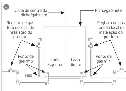
1. Observe a Figura 1 para identificar a posição do ponto de gás que você possui em sua residência para a instalação do fogão.
