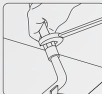
**2.** Coloque a arruela de vedação dentro da rosca interna da mangueira metálica.
